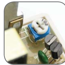
Возможность корректировки выходного напряжения
