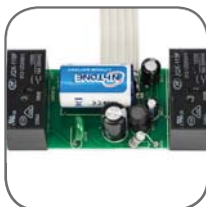
Два встроенных реле на токи до 16 А
